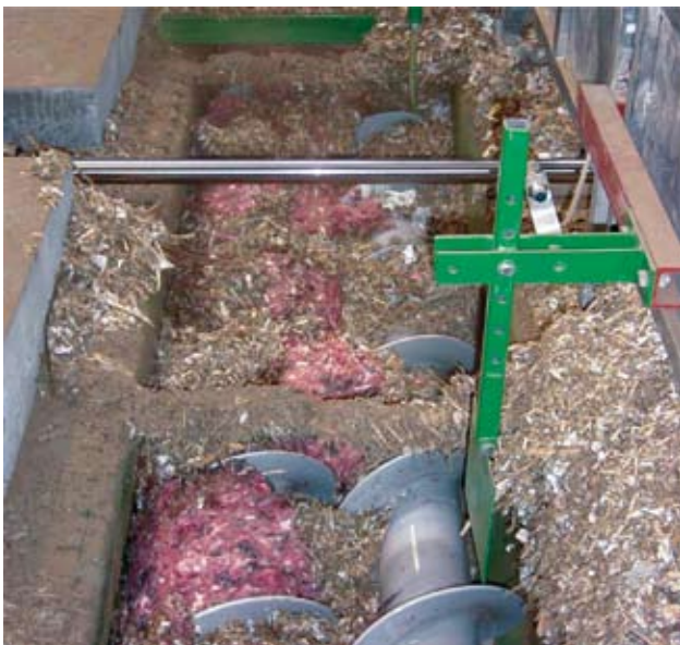
Sekoitusruuvi, joka sekoittaa seosaineen ja jauhetun sivutuotteen. (Kuva Preseco Oyj/Jan Granlund)
