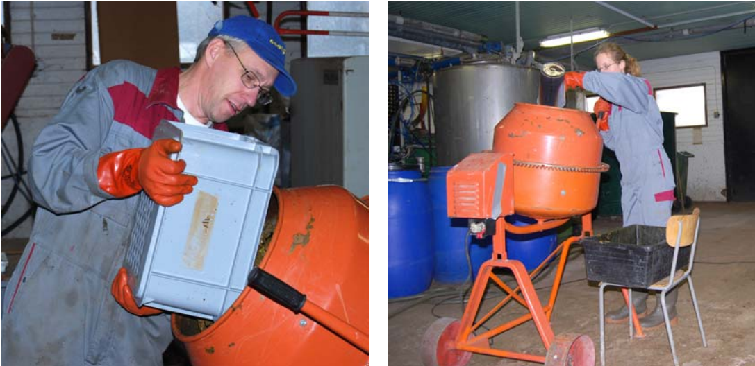
Figur 4. Blandning av slakteriavfall och tillsatsämne betongblandaren.
