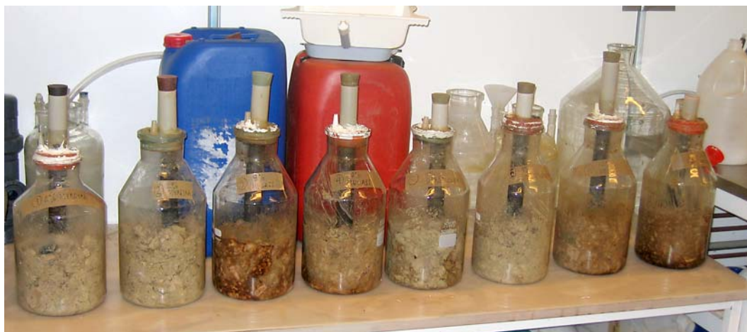
Figur 1. Bild på labbförsöket (utan gaspåsar). Med start från vänster är det myrsyra, 2 wt %, i behållare 1 och 2, melass, 8 wt %, i 3 och 4, strösocker, 4 wt %, i 5 och 6 och melass, 12 wt %, i 7 och 8.
