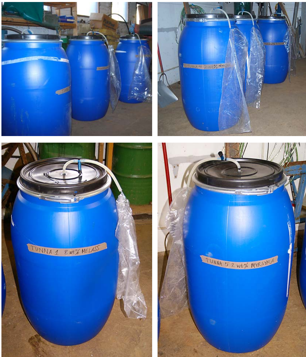
Figur 5. Uppställning av tunnorna med lock och gaspåse.
