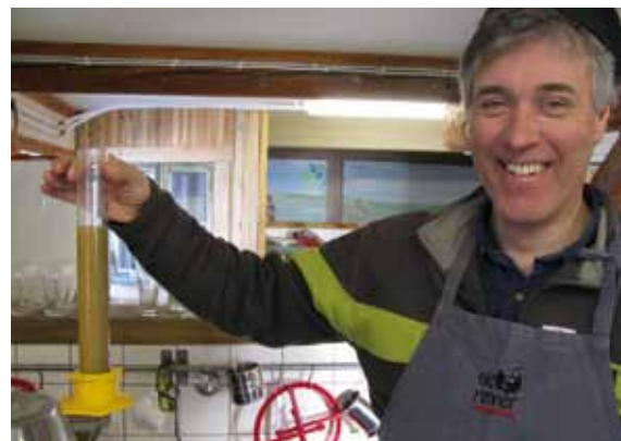
Öchslemätare används för att mäta sockerhalten. Sötvörten som lakas ur var ca 80 Ö i början och ca 20 Ö i slutet. Då blev hela blandningen 50 Ö. Vörten kyls i mätaglas till +20°C eftersom Öchslemätaren är kalibrerad vid +20°C. Denna gång var det Peter Windstedt som gjorde mätningen.
