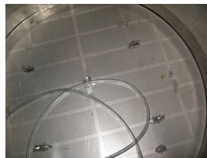
Den stora mäskgrytan i bryggeriet har ett galler i botten.
